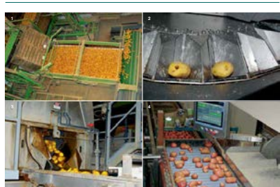
Dans les structures de conditionnement, les tubercules sont lavés et, un échantillon est analysé pour fixer la qualité du lot. Les tubercules sont lavés, puis triés optiquement avant d'être conditionnés et prêts pour la livraison
